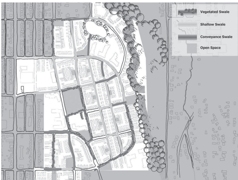
Figura 23: Esquema geral da grade verde de High Point Crédito: SvR Design Company
