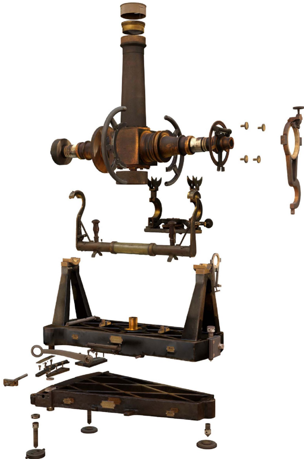
Figura 10 – Modelo digital da desmontagem da luneta Bamberg nº 10.783. Digitalização: Ricardo Marroquim e Daniel Coutinho. Renderização em Blender: Vítor Balbio, 2014.
