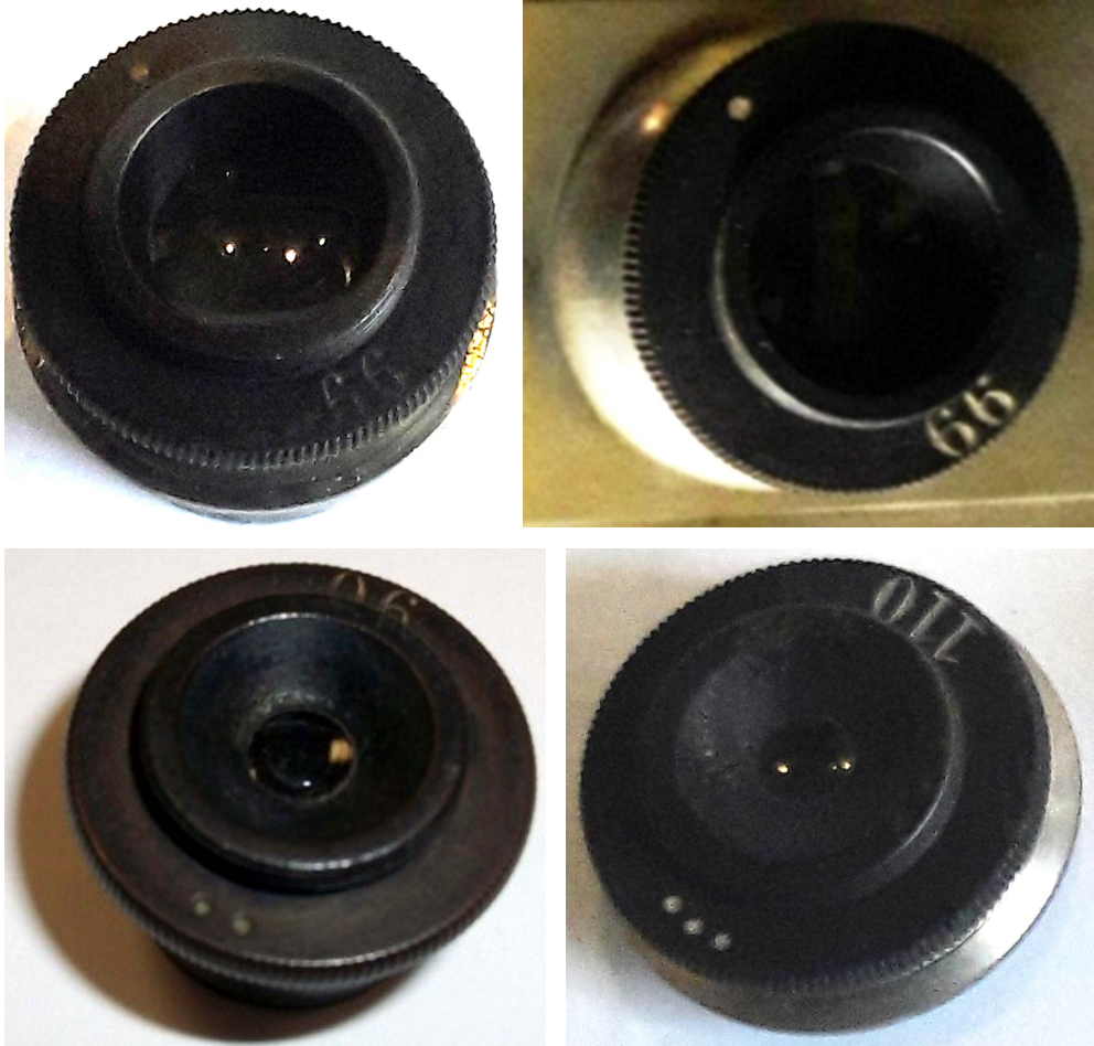
Figuras 3a, 3b, 3c e 3d – Lentes oculares do micrômetro da luneta nº 10.783 de Bamberg, cuja ampliação vem puncionada de fábrica. Fotos: Ricardo Dias, 2013.
