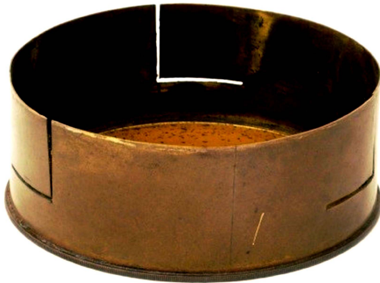
Figura 6b – Cortes na tampa original para encaixe. Fotos: Ricardo Dias, 2013.
