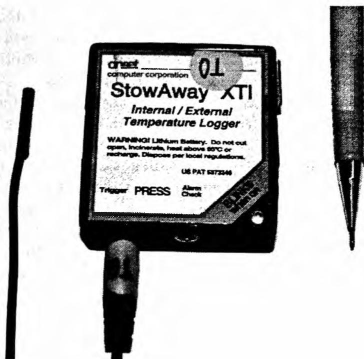
**Foto 1:** Termômetro minirregistrator digital, Stow Away XT102, ONSET, acervo do Laboratório de Climatologia e Biogeografia, USP.
