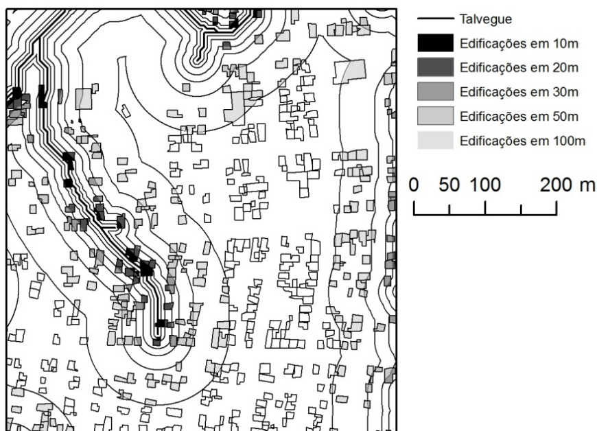
Figura 2 – Extrato da base de dados ilustrando geo-objetos da classe edificação nas faixas de entorno de geo-objetos da classe talvegue , nas distâncias de 10 m, 20 m, 30 m, 50 m e 100 m na bacia 2
