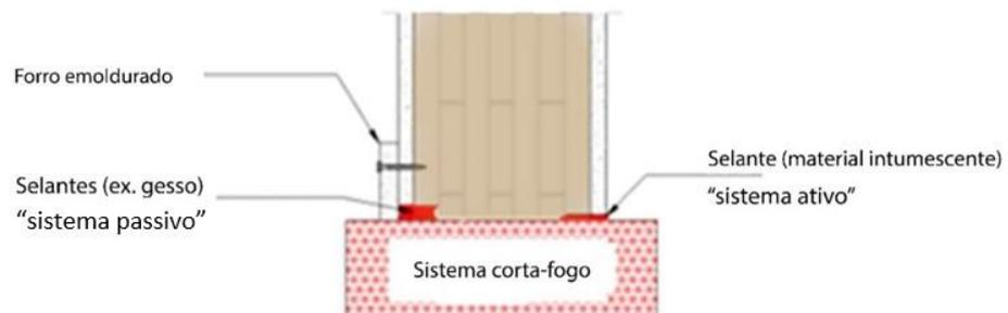
Sistemas com materiais intumescentes se expandem quando expostos a elevadas temperaturas, selando com eficácia o vão entre o elemento de CLT e as junções dos dispositivos corta-fogo. No caso de sistemas onde não ocorre essa expansão sob a ação do fogo, recomenda-se a aplicação de materiais como massa de gesso, ou um selante adicional
