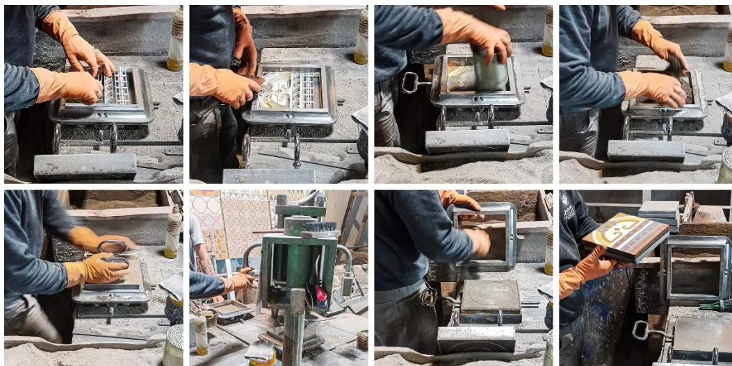
Figura 12. Etapas de fabricação do ladrilho. Fonte: elaborado pelos autores.
