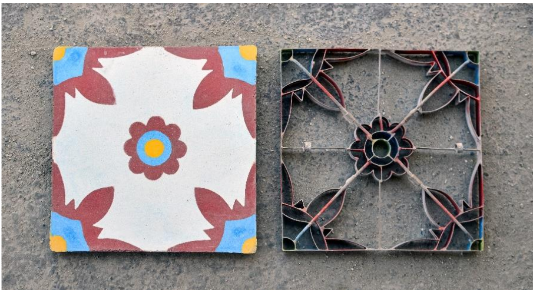
Figura 1. Ladrilho e molde divisor dos pigmentos, comumente fabricado em bronze ou aço. Fonte: dos autores.
