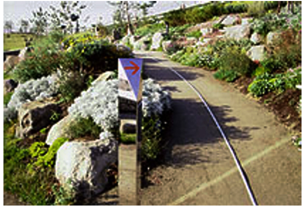
Figura 7. Guia de alumínio indicando o caminho recomendável, ou seja, sem obstáculos ou desníveis. Rinku Park , em Osaka, no Japão. Fonte: (MIYAKE, 2001).
