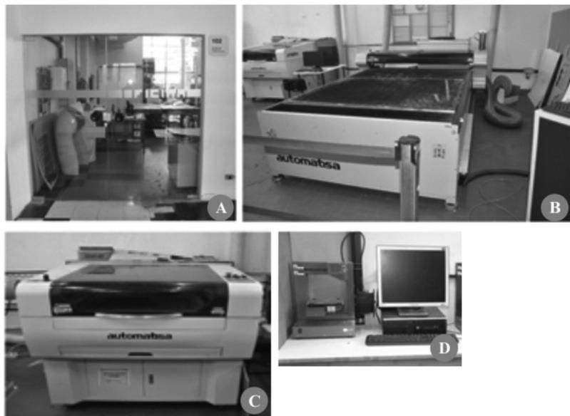
A máquina de corte a laser de 200 watts (modelo ACRILA, Figura 1B) proporciona um corte máximo de 1500 mm × 2500 mm. A máquina de corte a laser de 60 watts (modelo PRISMA, Figura 1C) proporciona um corte
