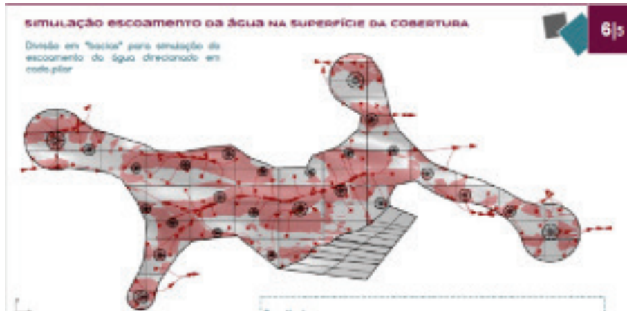
Figura 12: Simulação do escoamento da água pela cobertura, elaborado pelos estudantes Laura Rodrigues Parizi e Rafaela Mayumi de Almeida Silva Fonte: Desenvolvido pelos alunos da disciplina
