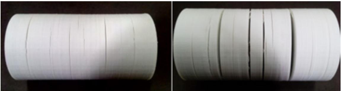
**Figura 7:** Descolamento das camadas após o fim da impressão, em poucas horas, e acentuada ao longo de alguns dias
