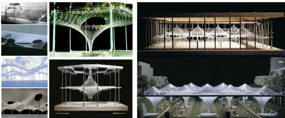
**Figura 5:** Modelo funicular (de corrente de suspensão) de Otto proposto para o Main Station Stuttgart
