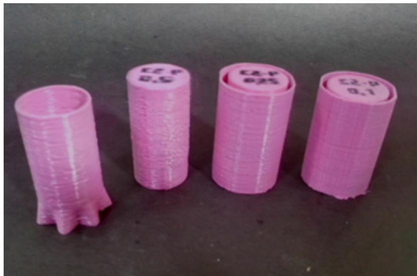
**Figura 6:** À esquerda, a camada indica extravasamento do material; os corpos de prova à direita possuem a casca de proteção criada para minimizar os problemas de impressão, decorrentes do descolamento das camadas
