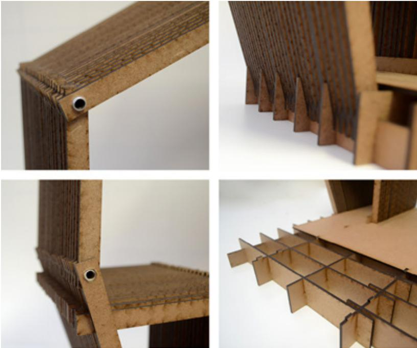
**Figura 8:** Detalhes do modelo em escala 1:5
