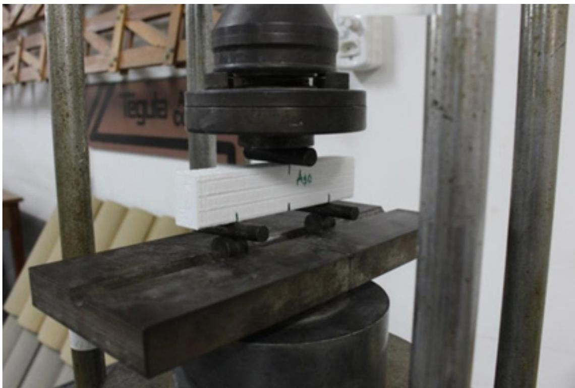
**Figura 5:** Preparação para o ensaio de flexão a três pontos
