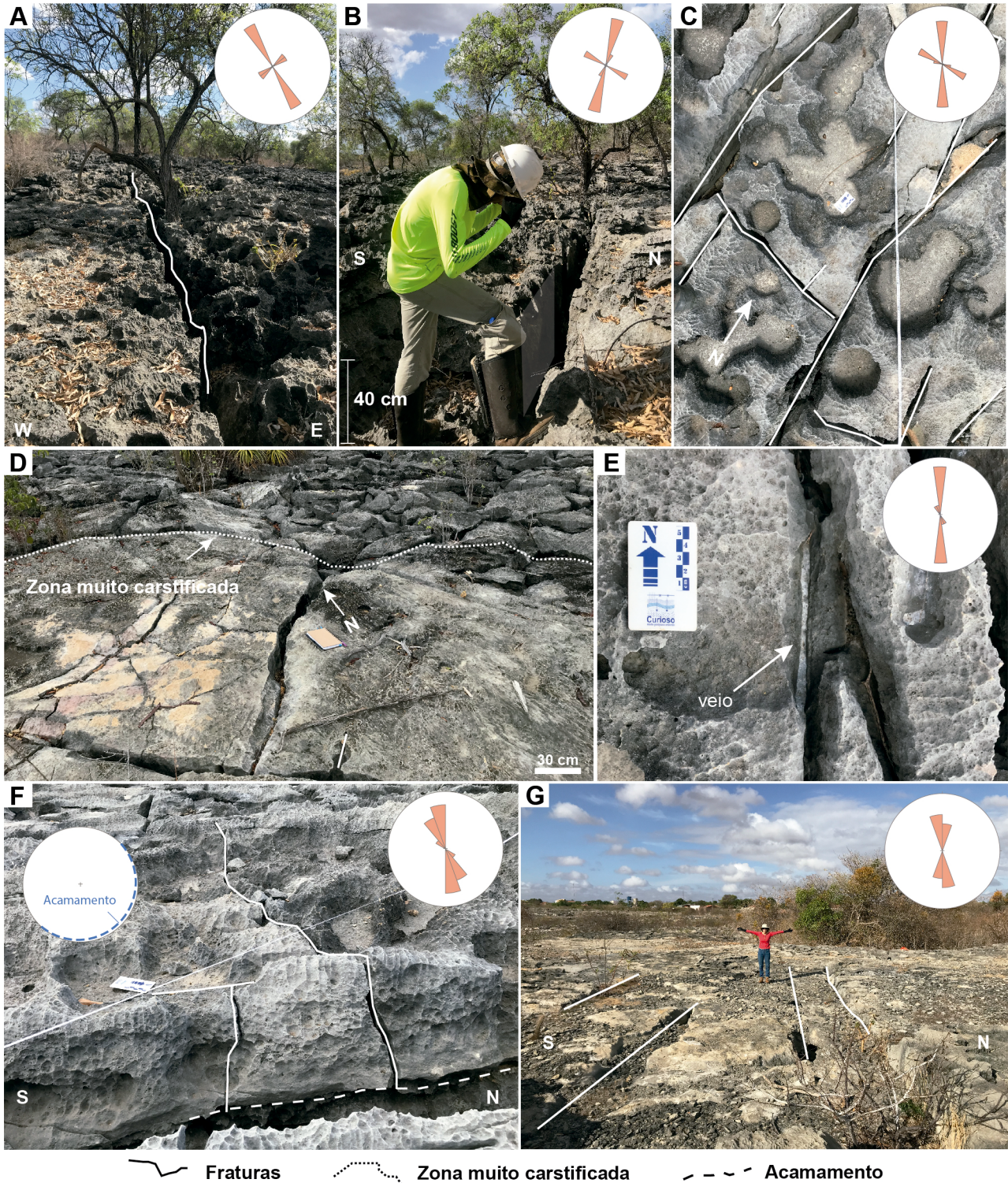
Figura 3. Fotos dos afloramentos estudados. (A), (B) e (D) Arapuaí II com grande variação no tamanho e profundidade das fraturas, com zonas muito carstificadas. (C), (E) e (F) Arapuaí I com juntas e veios preferencialmente N-S e NW-SE, sub-verticais, e casualmente sub-horizontais. (G) Arapuaí III apresentando menos fraturas, mais dispersas, extensas, de orientação E-W.
