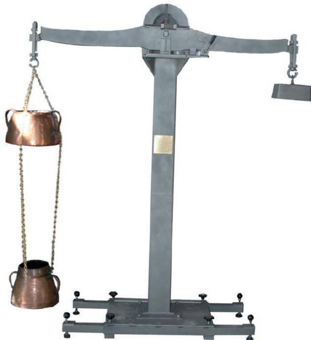
Figura 1. Uma reprodução física da balança de dois baldes de Galileu: o balde superior é preenchido com água e tem um orifício no seu fundo. No início do experimento o orifício encontra-se fechado, e a balança está em equilíbrio. Quando o orifício é aberto, a água escoar para o balde inferior. Inicialmente a balança desloca-se para o lado do contrapeso, e após o jato percutir o balde inferior o equilíbrio é restabelecido. Essa balança encontra-se na Universidade de Pávia, Itália<sup>3</sup>.
