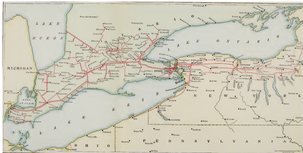
Figura 3: Mapa da rede de distribuição de energia a partir das cataratas do Niágara.
