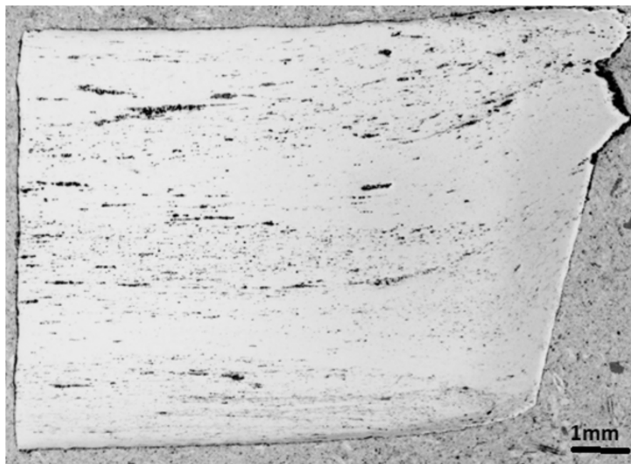
Figura 16 Superfície polida de corte longitudinal da barra de ferro maleável de 8 mm de diâmetro (amostra 131), da coleção do Museu Nacional, embutida em baquelite. As “fibras” escuras no interior da barra são inclusões de escória. Imagem do autor.
