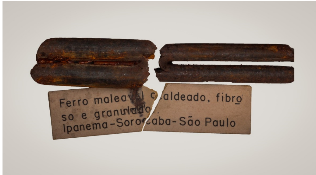
Figura 4 Dois dos objetos da Coleção do Museu Nacional. As duas barras mostram que foram dobradas a 180 graus e não romperam totalmente. Acompanha legenda da Coleção do Museu Nacional. Imagem de Augusto Camara Neiva.
