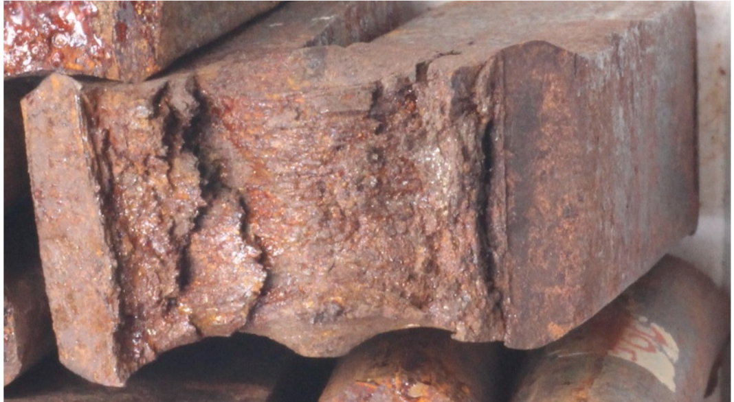
Figura 15 Aspecto da fratura de barra de ferro maleável. (amostra CHC 134). Fotografia de Augusto Camara Neiva.
