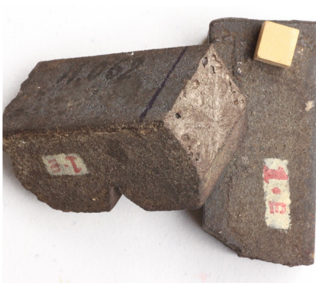
Figura 9 Lingote de gusa branco da coleção do Museu Nacional, mostrando a cor branca da fratura e a presença de porosidade no interior do material. Imagem do autor.
