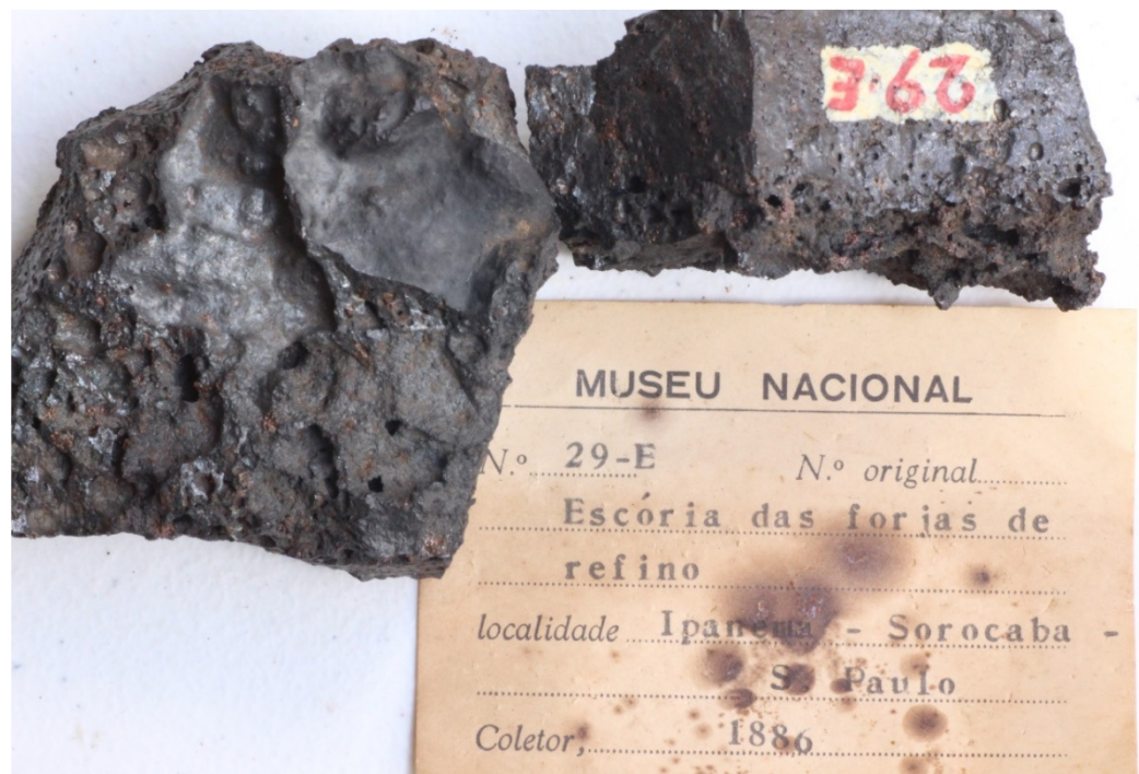
Figura 10 amostra de escória das forjas de refino de Ipanema, da Coleção do Museu Nacional. Foto de Augusto C. Neiva.
