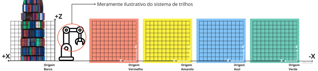
Figura 6 - Esquema ilustrativo da infraestrutura física de trilhos modelada
