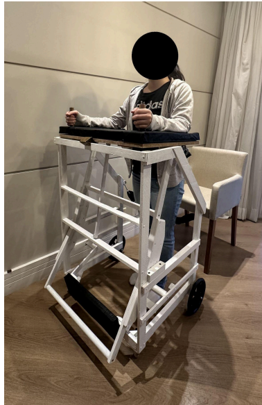
Figura 2 - Protótipo em madeira do andador
