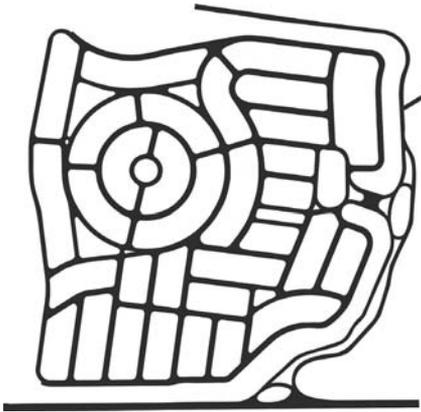
Figura 4: Estruturas em forma de rede. As vias internas estão integradas em um circuito fechado, com um único ponto de conexão com a área externa
