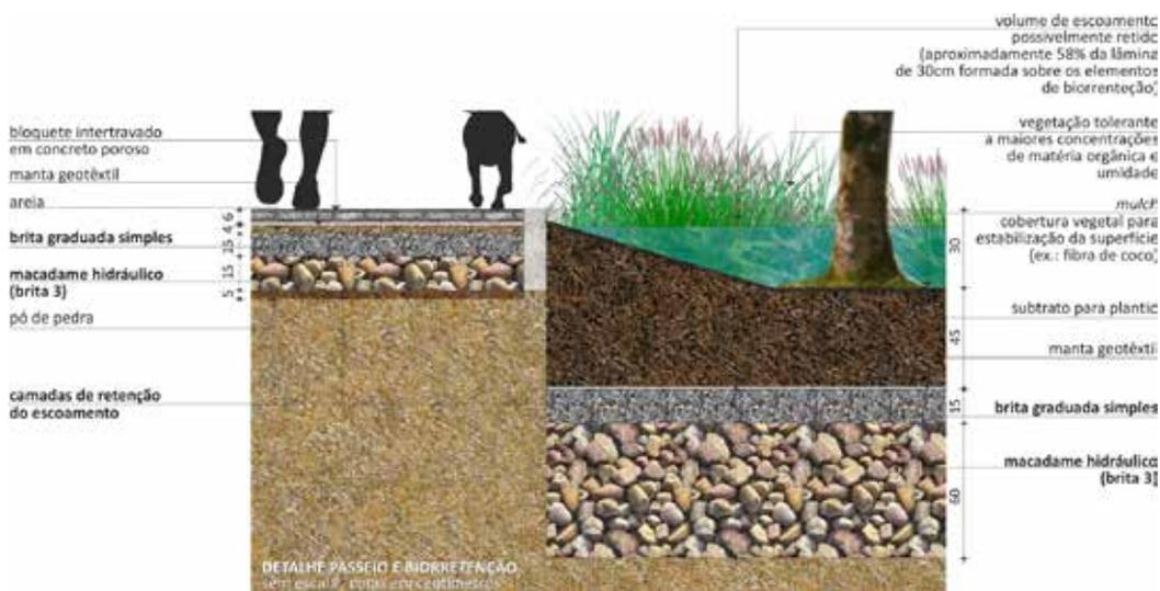
Figura 13 Detalhamento do passeio permeável do elemento de biorretenção.
