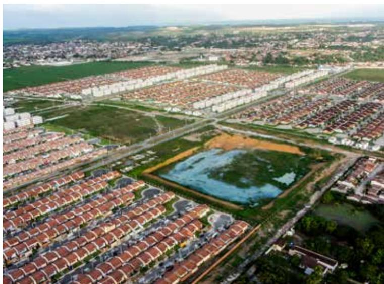
**Figura 7b** Empreendimentos MCMV no bairro Benedito Bentes. No centro, lagoa de detenção de águas pluviais.
