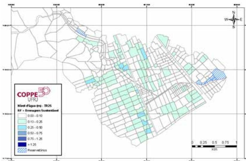
**Figura 2** Mancha de Alagamento - Requalificação Fluvial + Drenagem Sustentável (TR 25 anos).
