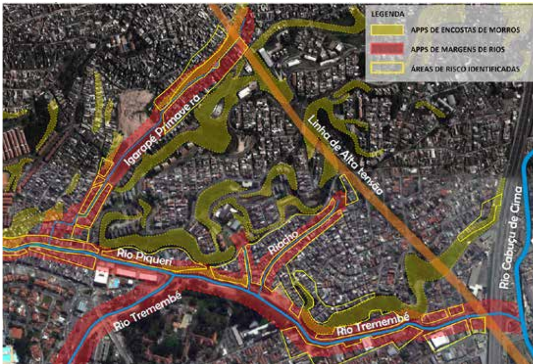
Figura 5 Área de intervenção escolhida. Manchas vermelhas indicam APPs nas margens dos rios. Manchas em amarelo indicam APPs nas encostas de morros. Poligonais em amarelo indicam áreas de ocupação irregular, precárias ou de remoção necessária para implantação da proposta de requalificação. Fonte: Elaborada por Gerson Amaral sobre base Google Earth. Disponível em: < https://www.google.com.br/maps/place/Trememb%C3%A9,+S%C3%A3o+Paulo+-+SP/@-23.4554394,-46.5813654,1357m/data=!3m1!1e3!4m2!3m1!1s0x94cef6f847876953:0x421ded09d34618c3 >. Acesso em: 3 jun. 2014.
