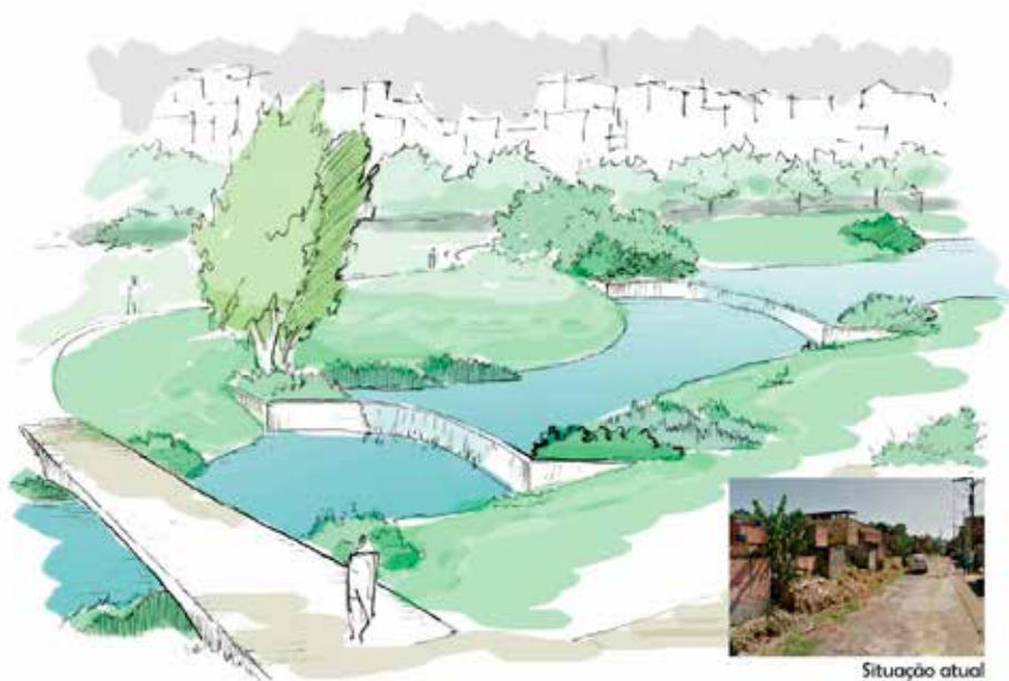
Figura 10 A retenção das águas das chuvas inclui o barramento de córregos para controle de vazão e criação de lagos, ampliando a presença do riacho na paisagem do bairro. O represamento sucessivo reduz a velocidade de escoamento, promove a decantação de sedimentos e ajuda na oxigenação da água, reduzindo o mau cheiro e facilitando a purificação através da biodegradação de poluentes. O plantio de espécies aquáticas e vegetação ripária contribui para a retenção de poluentes e abrigo para fauna. Fonte: Elaborada por Gerson Amaral – 2014
