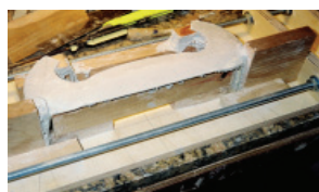
Figura 36: Braço horizontal construído e unido aos apoios extremos Crédito: Autor
