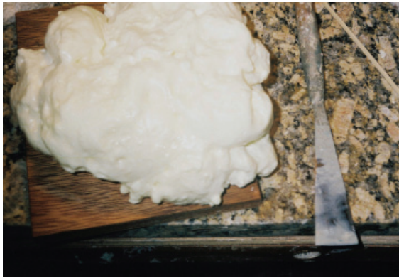
Figura 3: Cobertura com espuma de poliuretano Crédito: Autor
