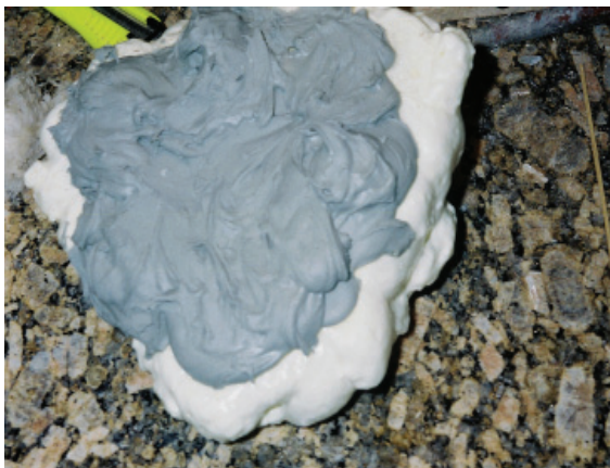
Figura 5: Resina poliéster despejada no molde negativo Crédito: Autor
