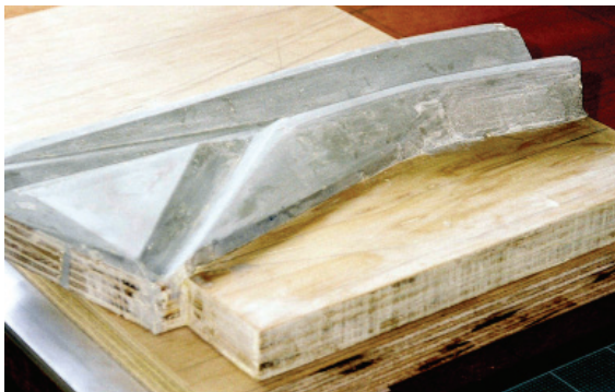
Figura 24: Molde lixado e preparado para confecção do contramolde Crédito: Autor
