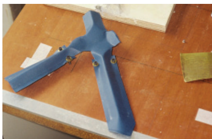
Figura 41: Experimento de reforço e enrijecimento, com folha de latão da parte inferior da aba triangular da peça Crédito: Autor
