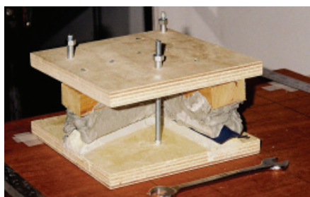
Figura 40: Molde e contramolde prensando folha de papel, com espessura dupla de 180 g/m 2 Crédito: Autor
