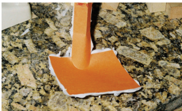
Figura 33: Molde inicial do apoio e parte da estrutura horizontal já com poliéster aderente ao modelo de papel com espessura simples Crédito: Autor
