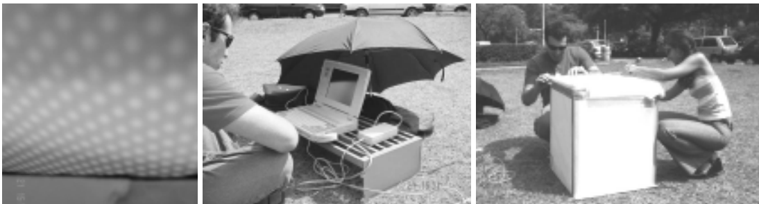
Figura 4 – Ensaio de transmissividade térmica e luminosa em cobertura têxtil Fonte: TFG Mônica Marcondes – Centro de Tecnologia e Educação Ambiental
