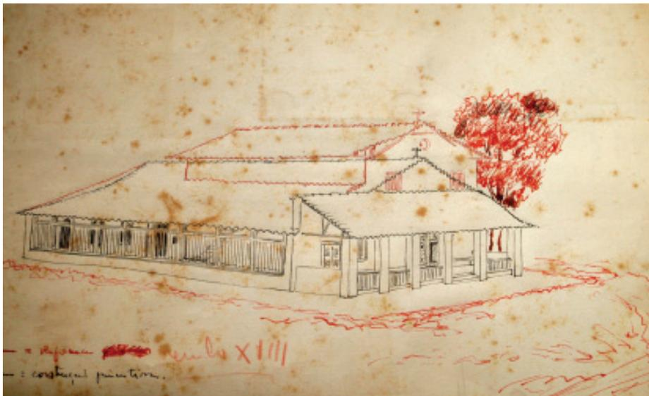
Figura 6: Croqui de Luis Saia reproduzindo, em preto, a hipótese de configuração da capela primitiva, e destacando, em vermelho, o alteamento da nave. Na lateral, desenha o gradil proposto
