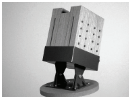
Figura 11: Detalhe de conexão entre base de pilar e arco em madeira laminada (esc. 1:5) Crédito: Foto da autora, São Paulo, 2005
