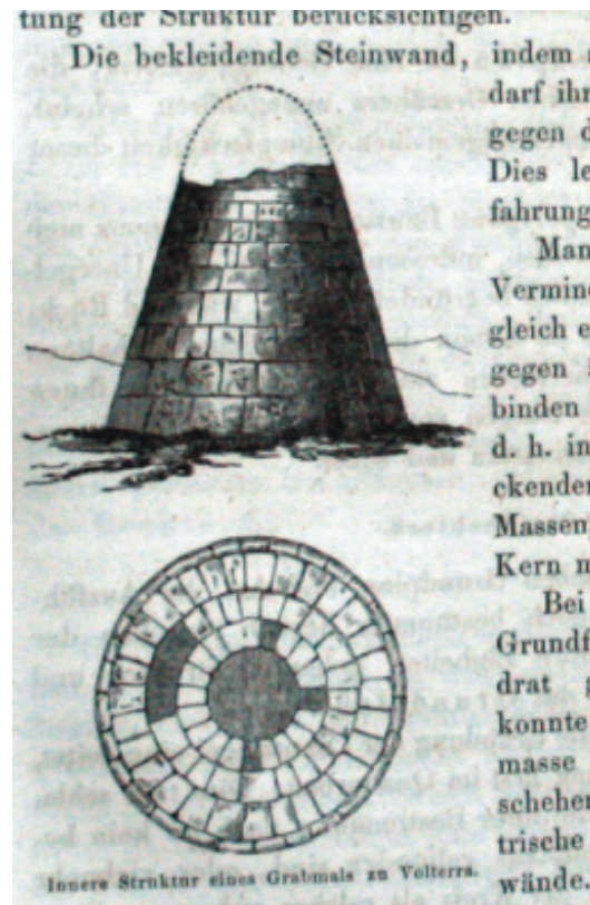
Figura 5: Imagem da edição de 1860 de Der Stil , ilustrando a arte da estereotomia, entendida como arte de talhar e construir com pedras, que, a partir de pequenos elementos maciços, dá forma a estruturas como muros, cúpulas e abóbadas Fonte: Domínio público
