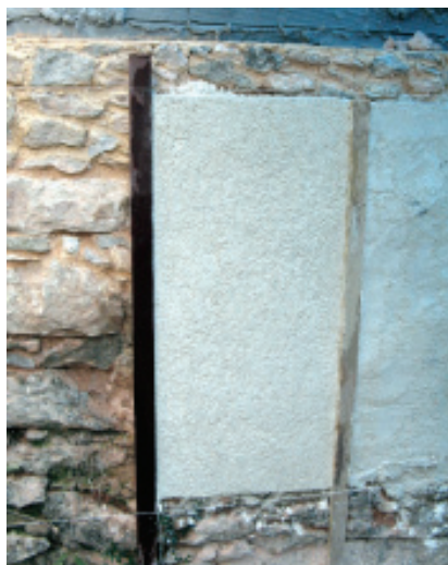
Figura 7: Argamassa-teste grupo A1 – acabamento desempenado para o emboço Fonte: Arquivo FCRB, por Thiago Turino
