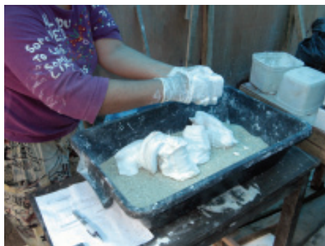
Figura 5: Preparo das argamassas-teste grupo A Fonte: Arquivo FCRB, por Thiago Turino
