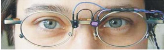
Figura 4: *LuxBlick* - Dois sensores são fixados na armação de óculos.
