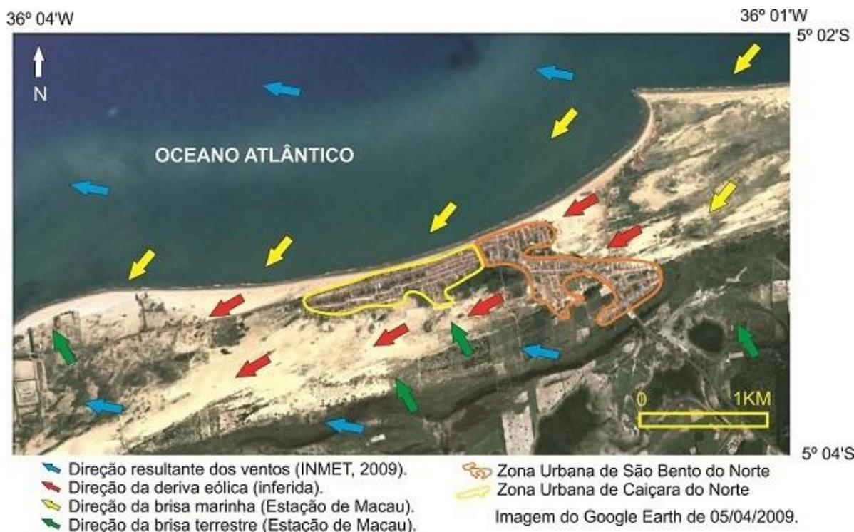
**Figura 2:** Direção resultante dos ventos, direção da deriva eólica, direção da brisa marítima (marinha) e direção da brisa terrestre entre São Bento do Norte/RN e Caiçara do Norte/RN. Fonte da imagem: Google Earth (Google.com ©). Fonte dos dados INMET.
