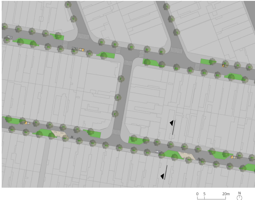
Figura 15 – Planta baixa mostra o tratamento de ruas que receberão canteiros pluviais. A via mais ao sul é a rua Vereador José Gomes de Moraes Neto
