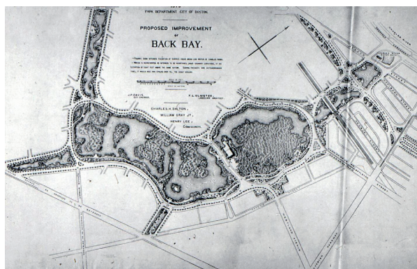
Figuras 6 e 7 – Na primeira proposta de Olmsted (1879), à esquerda, havia plantio convencional de árvores no perímetro, o Stony Brook entrava na bacia na altura do cruzamento da Huntington avenue com a Parker St. É possível ver a comporta do rio Muddy ao norte. À direita, no plano de 1885, o Stony Brook já não se liga à bacia. Fonte: < http://www.olmsted.org >. Acesso: 20/08/2014.
