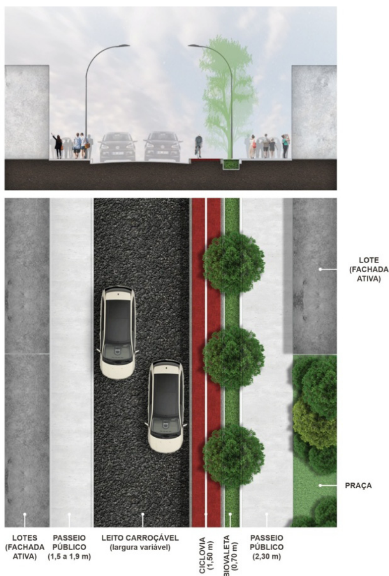
Figura 07 – Planta e Corte esquemático da Rua Paula Souza – Eixo Cultural (esquerda). Fonte: Elaborado pela autora, 2017
