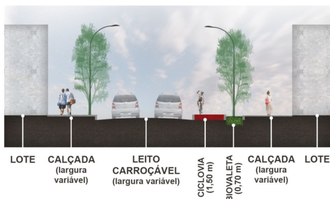
Figura 06 – Corte esquemático propositivo das Ruas Verdes. Fonte: Elaborado pela autora, 2017
