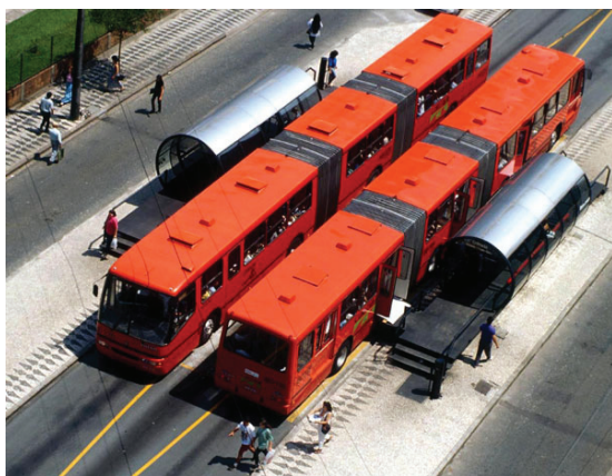
Figuras 4 e 5 – O primeiro sistema BRT em que mostra suas linhas exclusivas e alinhamento no centro das vias. No detalhe, o acesso da plataforma ao ônibus em nível. Ambos os procedimentos para reduzir atrasos no embarque e desembarque. Fonte: < http://www.brtrbrasil.org >.
