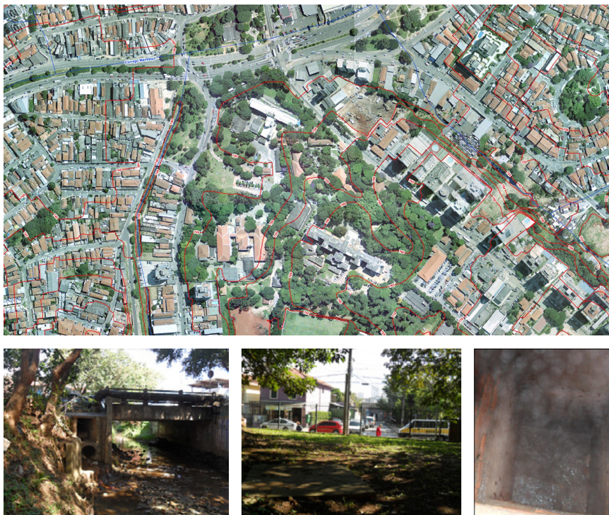
Figura 9 – Imagem maior, no topo, mostra as curvas de nível (em vermelho) que sugerem a presença de um córrego. Fonte: GeoSampa. Abaixo, a investigação in loco revela tubulação suspeita chegando ao leito do córrego Água Preta (à esquerda), na esquina da travessa Dagmar com rua Pellegrino. Dentro do complexo hospitalar Mandaqui, uma pesada tampa também suspeita (no centro) e a água fluindo em seu interior (à direita). Fotos do autor.
