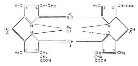
A substituição do *Cl* pelo *OH*, que os alcalis realizam facilmente, transforma a clorhemina em oxihemina. Tratando-se uma solução potássica de clorhemina, pelo ácido acético; lavando-se e secando-se o precipitado obtido; dissolvendo-se este pela piridina; filtrando-se a solução e ajuntando-se à mesma eter de petróleo, conseguir-se-ão belos cristais de oxihemina, a verdadeira hematina (Hans Fischer).
